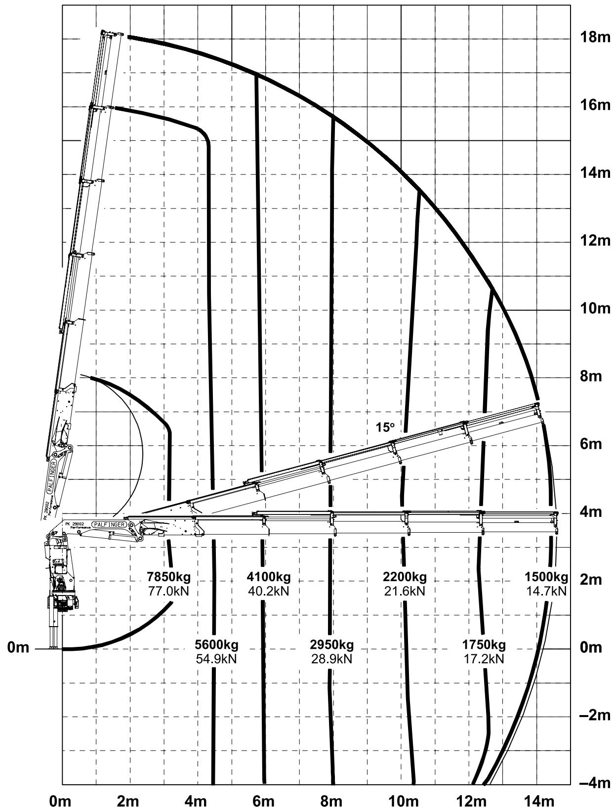
Die Tragkräfte laut Diagramm verringern sich bei Verwendung von mechanischen Verlängerungen um deren Eigengewicht.
